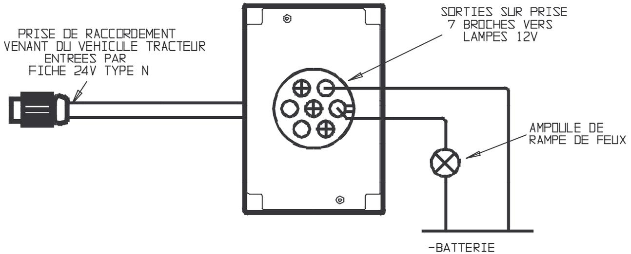
**ENTREES :** Raccorder la fiche 24V de l'adaptateur au véhicule tracteur.
