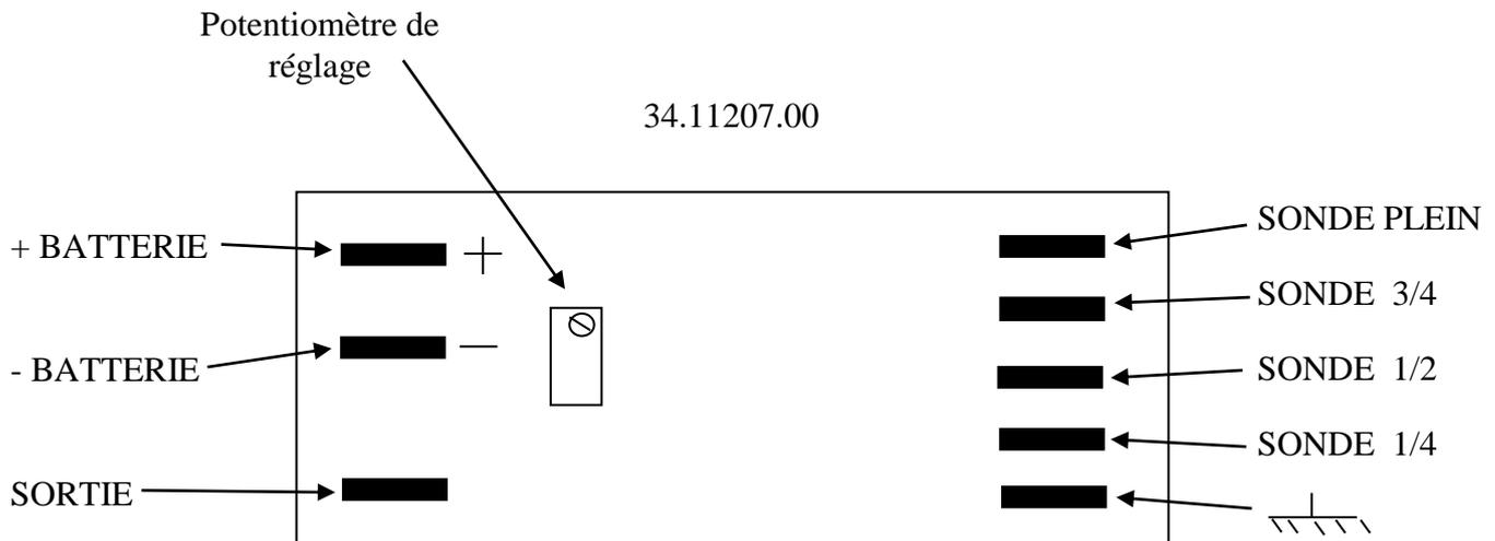
Il faut câbler le **+Générateur** (tension de 12v) de la centrale 09.312.0 sur le **+Batterie** de l'adaptateur, et la **sortie générateur** sur la cosse **sortie**, sans oublier la masse.
